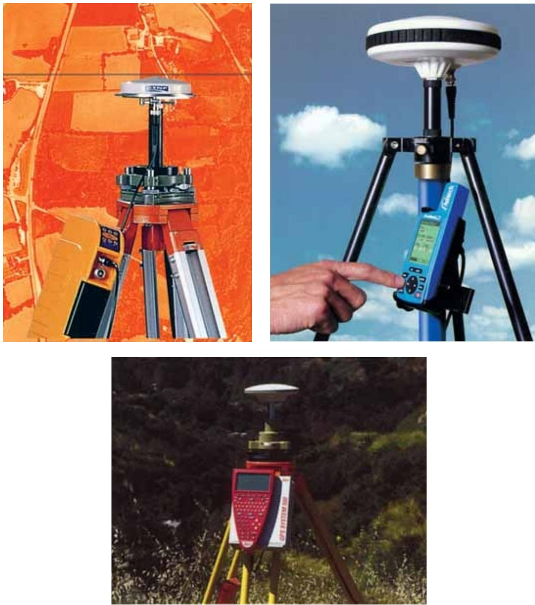
شکل ۷-۵- چند نمونه گیرندهای دقیق تعیین موقعیت ماهواره‌ای (GPS)
